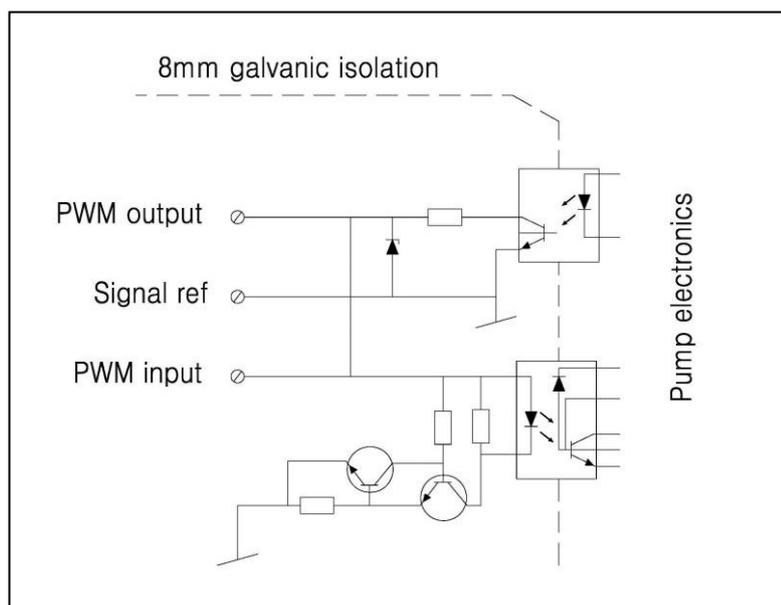
La pompa è controllata da parti elettriche esterne tramite interfaccia. L'interfaccia commuta il segnale esterno per segnalare che la pompa può funzionare. Inoltre, quando la tensione di ingresso della pompa è compresa tra 220V e 240V, l'interfaccia garantisce che l'utente incontri la linea del segnale senza il rischio di shock ad alta tensione.
